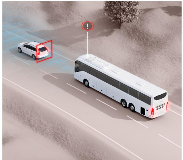
Alle basse velocità, tipiche del traffico cittadino, il tempo calcolato per l'impatto è ridotto. In questi casi, la fase preliminare della frenata è appena percettibile, mentre a velocità più elevate le due fasi si distinguono chiaramente. La frenata continua fino all'arresto o alla scomparsa del rischio di collisione. La frenata può essere esclusa dal conducente tramite kickdown sull'acceleratore.
