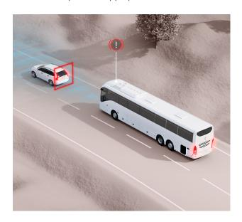
À faible vitesse, typique du trafic urbain, le temps jusqu'à l'impact est court, rendant la phase de pré-freinage à peine perceptible. En revanche, à des vitesses plus élevées, les deux phases sont nettement distinctes. Le freinage se poursuit jusqu'à l'arrêt complet du véhicule ou jusqu'à l'élimination totale du risque de collision. Le freinage peut être désactivé par le conducteur en appuyant sur l'accélérateur.
