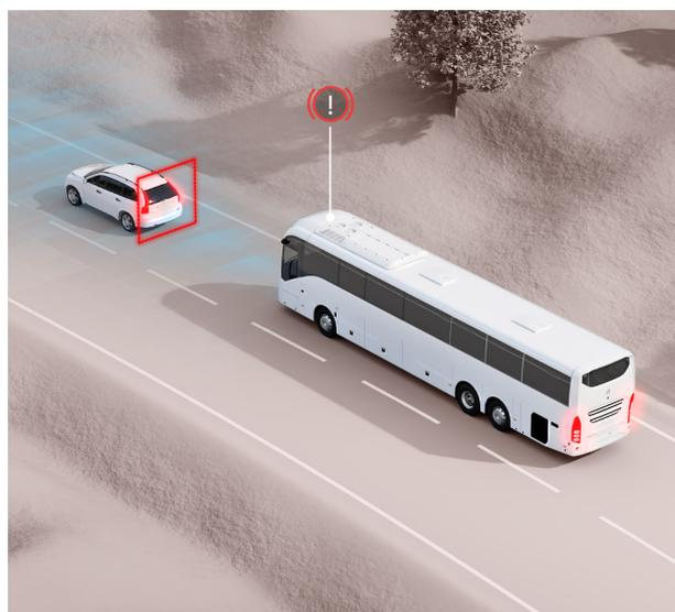
velocidad del vehículo, pero que además funciona como señal de alerta física para el conductor. Si, luego de esta secuencia, el conductor no toma ninguna medida activa, se incrementa la fuerza de frenado hasta llegar al frenado de emergencia total.
